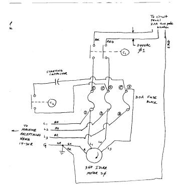
ALL POWER WIRES #10 AWG BLACK THAN ALL GROUND WIRES #10 AWG GREEN THAN
